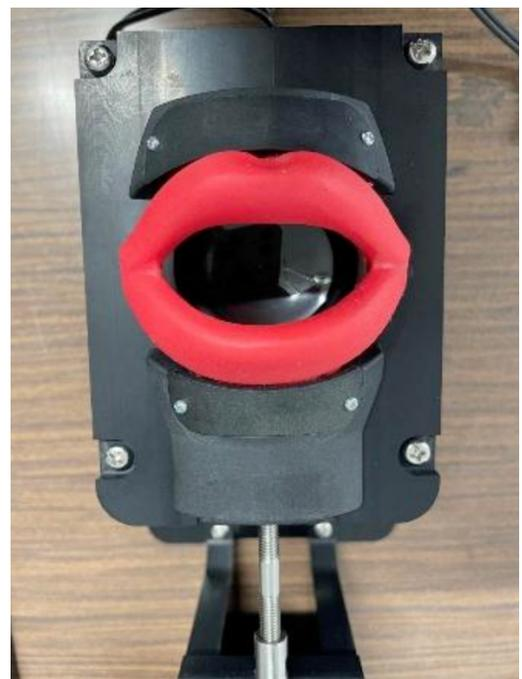
Fig. 5 アクチュエータを用いて口唇モデルを機械的に制御する装置[12]
