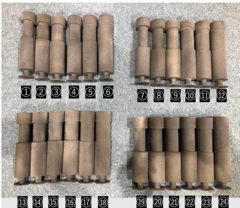
Fig. 1 英語母音[ε]に対して試作された24種類の声道模型[6]
