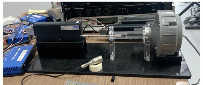
Fig. 4 アクチュエータにより VTM-S24 を機械的に制御する装置[11]
