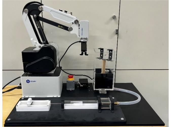
Fig. 3 スライド式3音響管モデル (VTM-S24) をロボットアームにより制御する装置[10]
